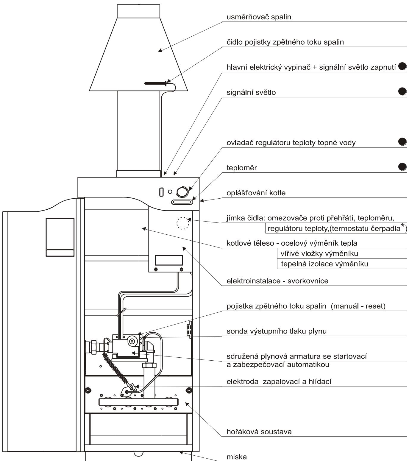
\* -termostat čerpadla typ TG 712.20328.20A (v případě nutného oběhu) montovat do určeného místa uvnitř elektroskříně, po odstranění pružné vložky vsunout čidlo do jímky, elektrozapojení čerpadla a termostatu provést dle požadavku projektanta
